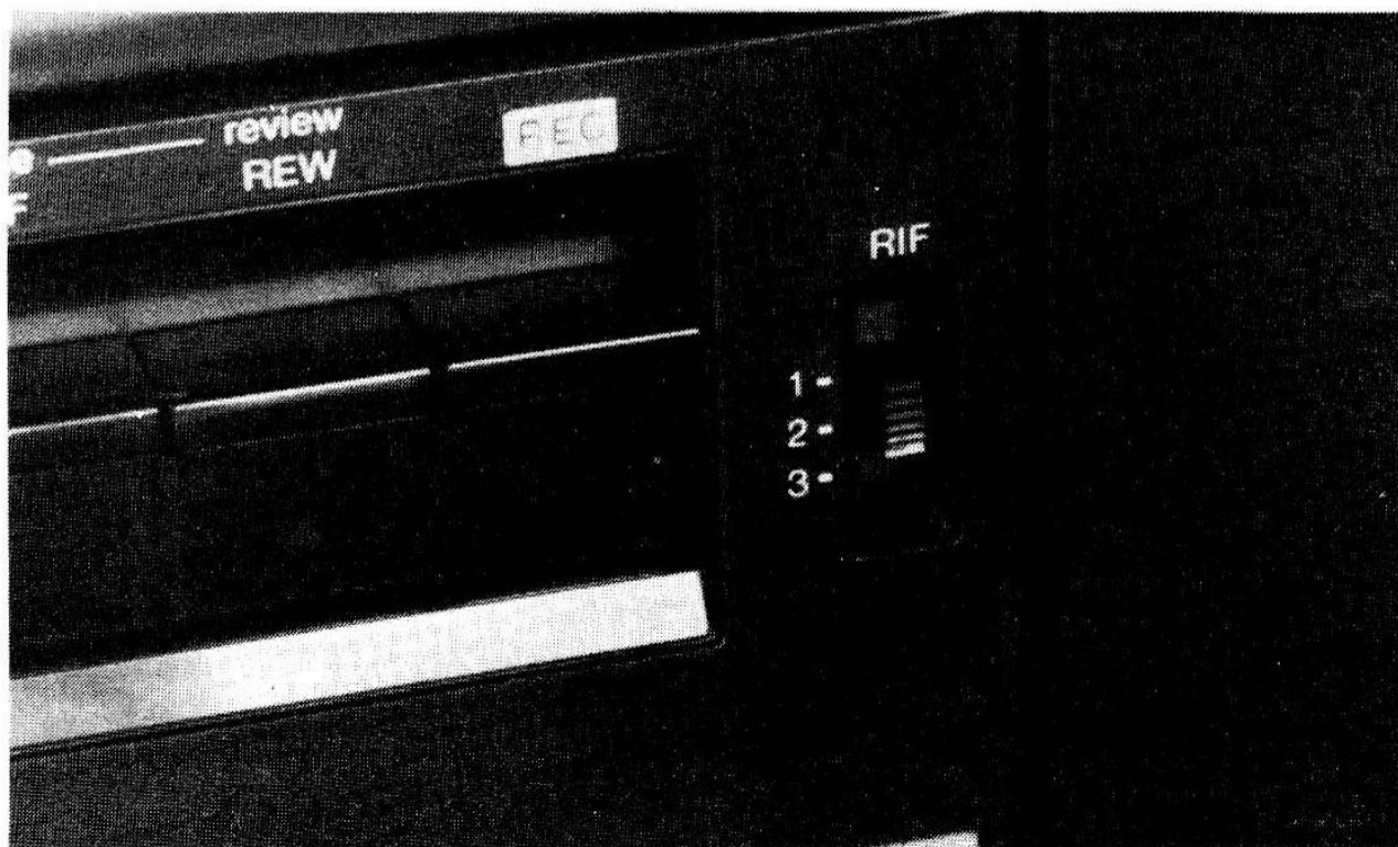
Un exemple de sélecteur anti-battements.
